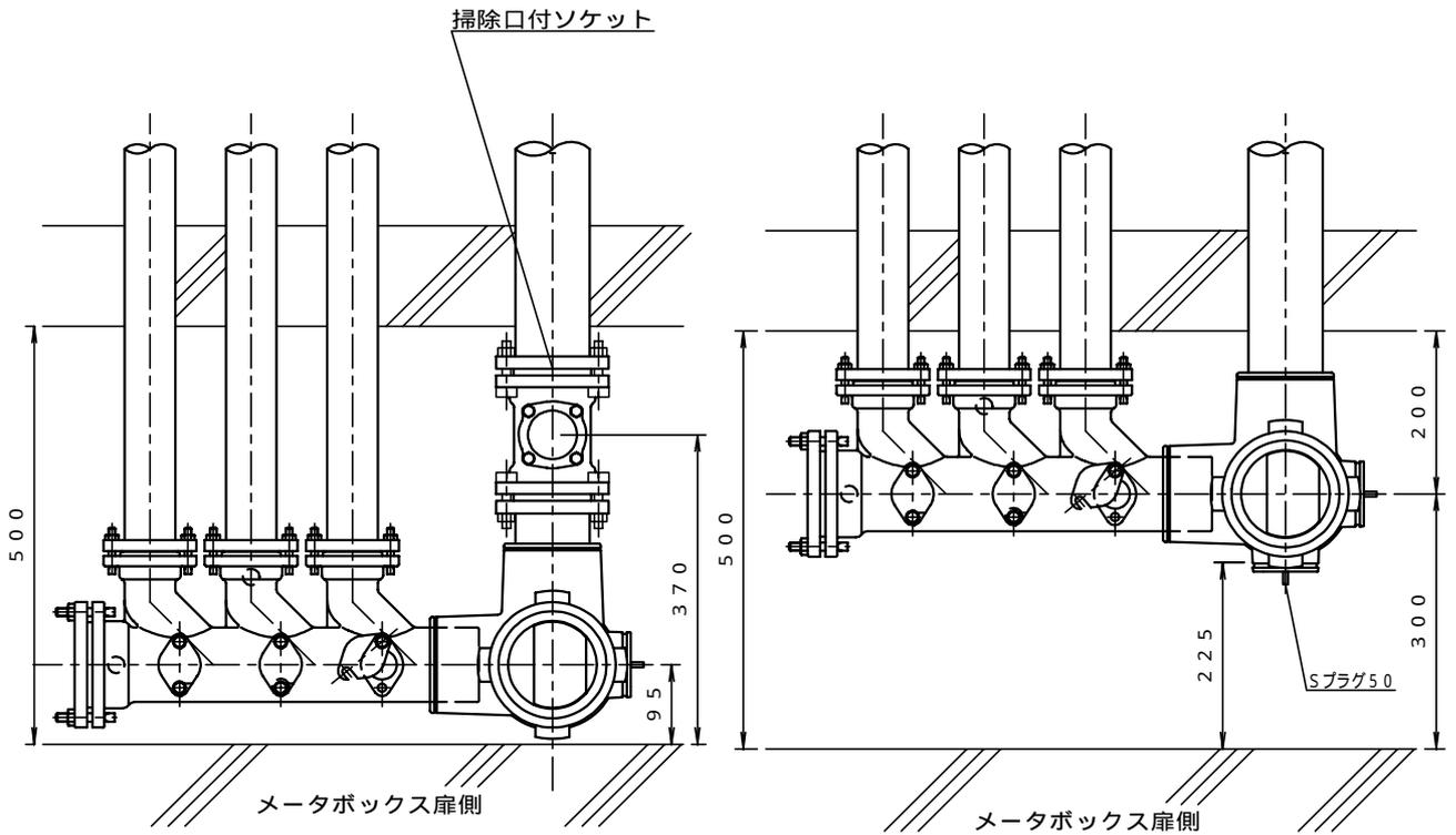
掃除口付ソケットのフランジ頂部がP S床面に当たるので、横枝管の芯高さが75 mm以上必要です
