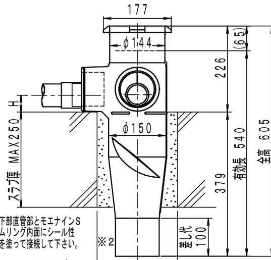
※2継手下部直管部とモエナインSのゴムリング内面にシール性滑剤を塗って接続して下さい。
