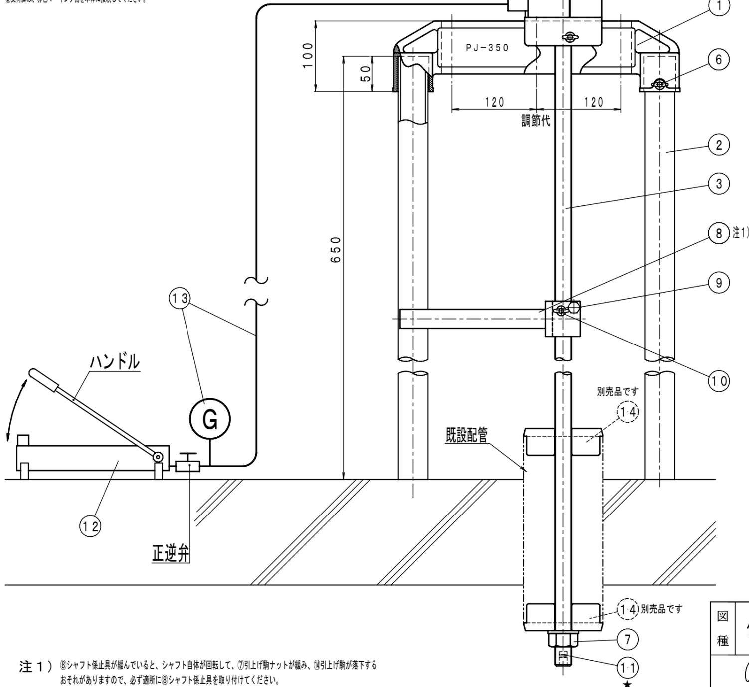
注1) ⑧シャフト係止具が緩んでいると、シャフト自体が回転して、⑦引上げ駒ナットが緩み、④引上げ駒が落下するおそれがありますので、必ず適所に⑧シャフト係止具を取り付けてください。
