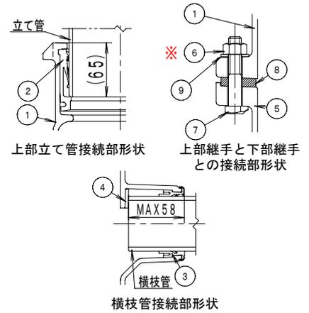
※ 上部継手と下部継手は、それぞれの横枝管接続口の向きが、品番・呼びに示された位置関係になるように、相互に嵌ませたキーによって、位置決めされボルト・ナットで固定されています。
