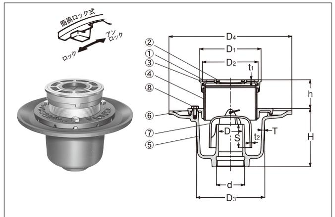
◎ストレーナを取り外す場合には、合印▽を金具枠の合印△の位置に合わせて引き上げて下さい。
