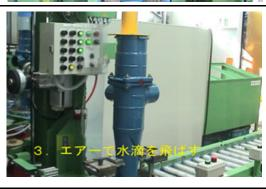
●継手内部の水滴を、エアーで吹飛ばします。
