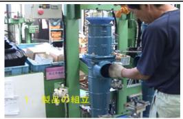
●上部継手と下部継手の組立工程です。
