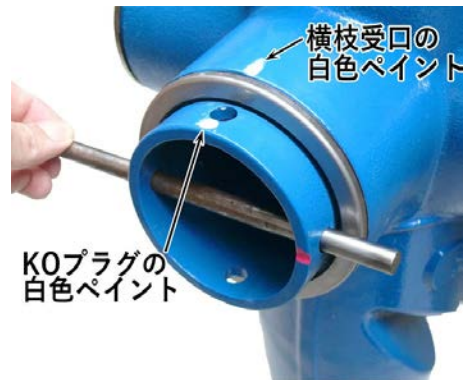
固定時（ロック） 横枝口上面（白色）とKOプラグ（白色）を合わせる
