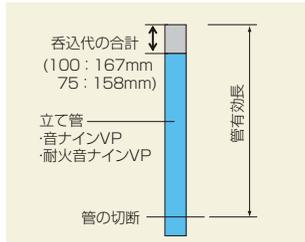
立て管(音ナインVP又は耐火音ナインVP)の防音材を端面から、上下の呑込代と施工余裕代の合計分(呼び100:167mm、呼び75:158mm)を片側にスライドさせ、裸管側の管端から管有効長の位置で管を切断する。
