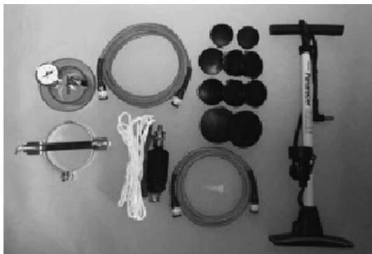
満空試験治具 標準セット (写真LTCS 100)
