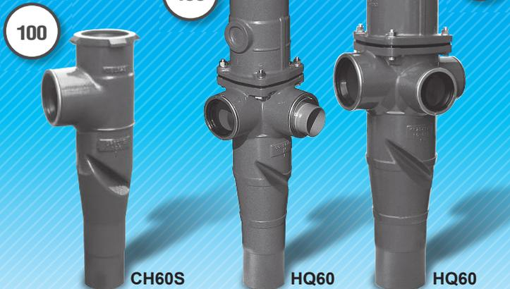
**コヨがミツ!** コアジョイントHQは上部継手に設けた減速ガイドと、下部継手に設けた相互に交叉する平滑な形状の対向2枚羽根の連携作用により、縄をなうような旋回流をパワフルに形成します。
