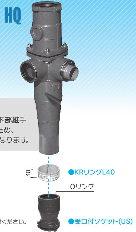
HQ・US工法は、HQジョイントの上部・下部継手を取り外して更新するため、やり取り代が40mmとなります。
