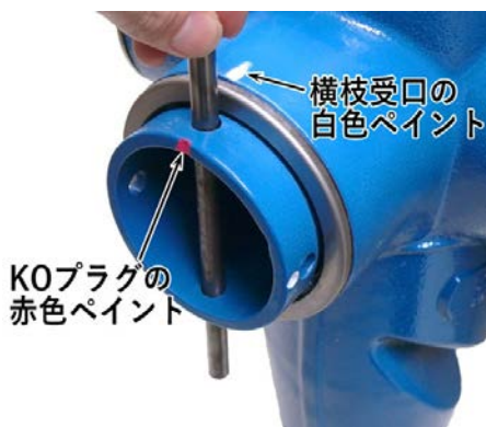
挿入時（アンロック） 横枝口上面（白色）とKOプラグ（赤色）を合わせる
